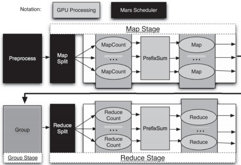
以Mars的word count为例，Mars读取文件，将文件切分为ceil（2048）大小的一块，这里的ceil（2048）是指 $\geq 2048$ 字符长度的连续字符，即块以非空字符开始，结尾是偏移 $\geq 2048$ 字符长度的第一个空字符的前一位。每一块分配给一个GPU thread，256个thread组成一个block，多个block组成一个grid，一次GPU内核函数调用执行一个grid。从调度和运行方式看，GPU上block概念和CPU上的进程很相似，一个进程占用一个CPU核运行，多个进程轮转调度；一个block占用一个GPU SM运行，多个block轮转调度。从这个角度看，GPU的SM很像GPU核。
